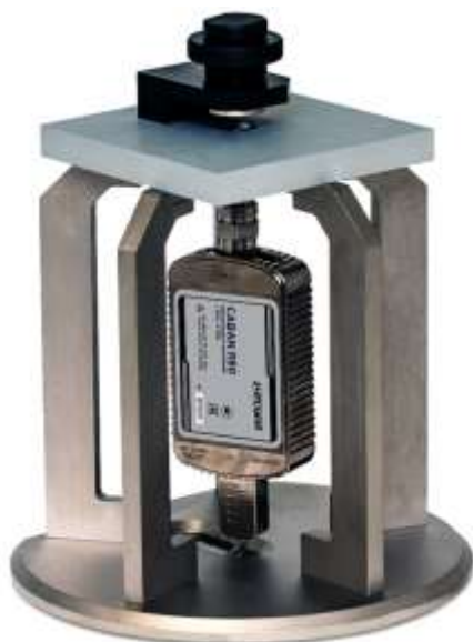
Рисунок 1 – Установка для измерений параметров твердых плоских диэлектриков
