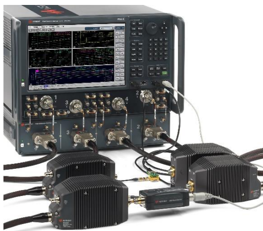
Рис. 1. Анализатор цепей с контроллером измерительного блока и модулями расширения частотного диапазона
